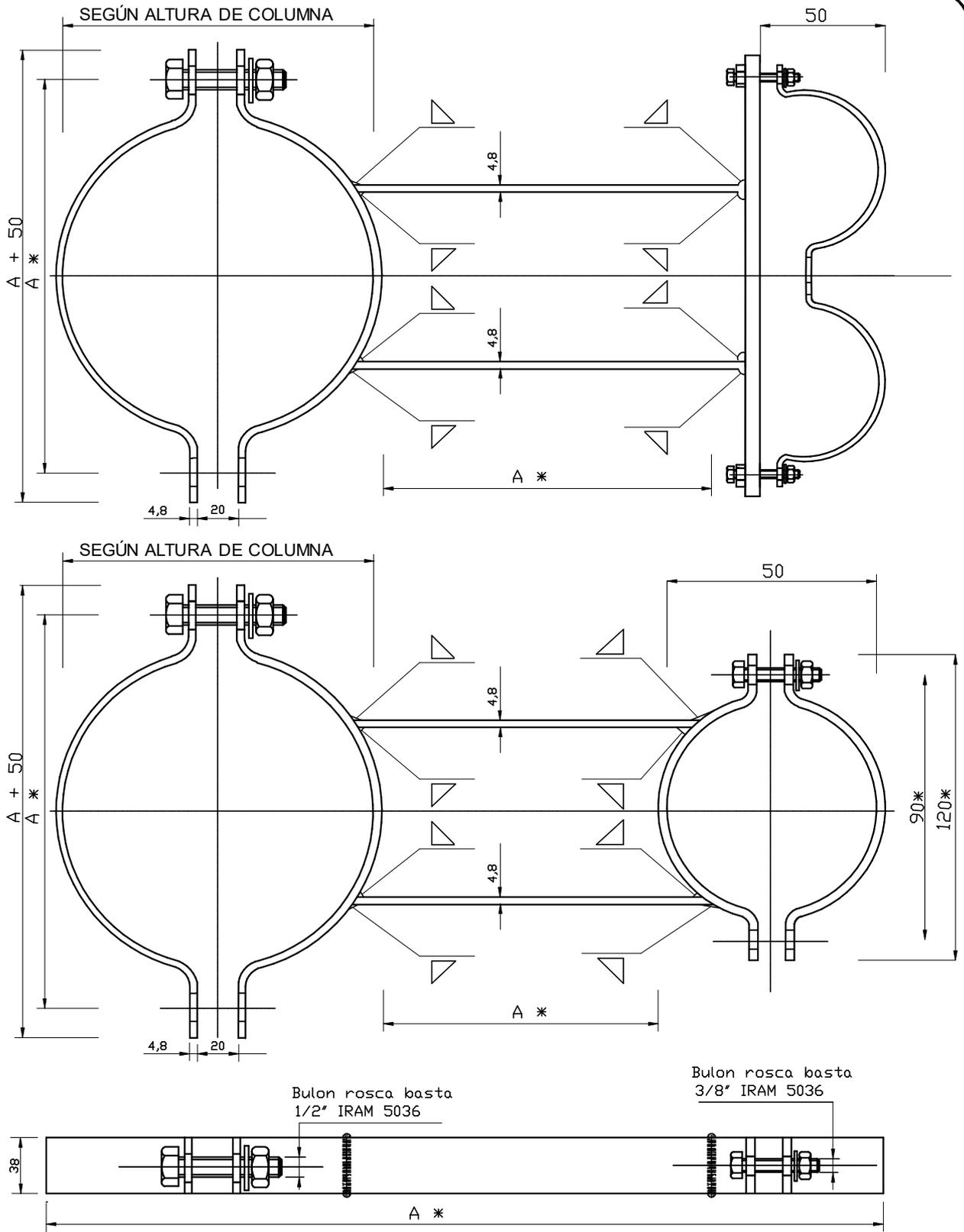
(A \*) SEGÚN ALTURA DE COLUMNA: Medidas a ajustarse en obra.
